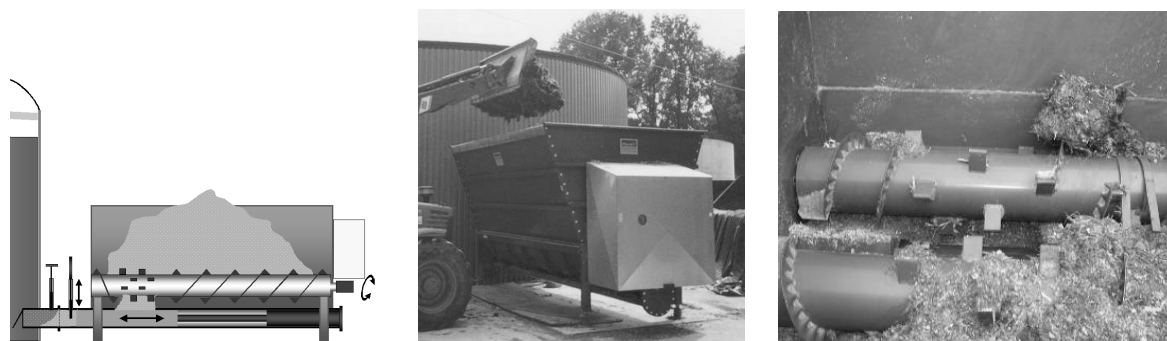
Ilustracja 3-26: Wprowadzanie składowanej luzem biomasy za pomocą tłoka podającego; zdjęcie: PlanET Energietechnik
