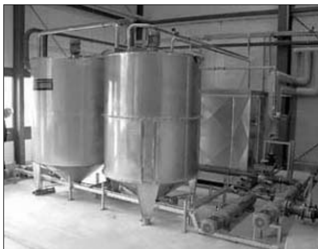
Ilustracja 3-16: Higienizacja z układem chłodzenia nagrzanego chłodziwa; zdjęcie: TEWE Electronic GmbH & Co. KG
