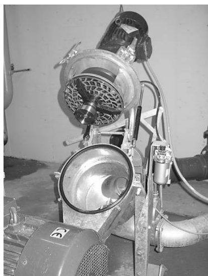
Ilustracja 3-18: Rozdrabnianie substratu w przewodzie tłoczącym; zdjęcia: Hugo Vogelsang Maschinenbau GmbH
