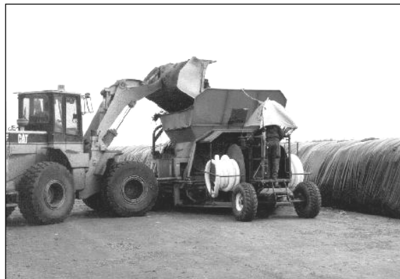
Ilustracja 3-11: Napełnianie rękawa foliowego; zdjęcie: B. Linke, Institut für Agrartechnik Bornim
