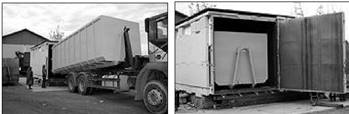
Ilustracja 3-9: Fermentator wsuwany umieszczony w hakowym kontenerze załadowniczym, stadium prototypowe; zdjęcie: Bioferm GmbH
