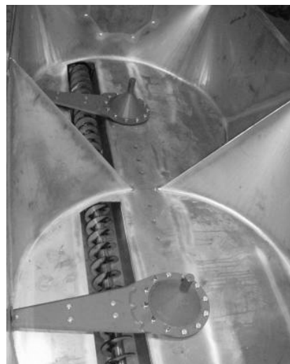
Ilustracja 3-17: Wstępny zbiornik magazynowy z agregatem rozdrabniającym; zdjęcia: Konrad Pumpe GmbH
