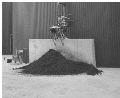
Ilustracja 3-40: Separator ślimakowy; rysunek: FAN Separator GmbH; zdjęcie: PlanET Energietechnik
