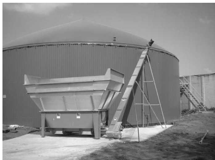
Ilustracja 3-17: Wstępny zbiornik magazynowy z agregatem rozdrabniającym; zdjęcia: Konrad Pumpe GmbH
